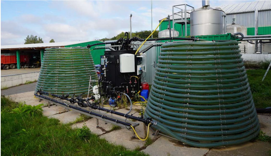
Abbildung 3 GICON®-PBR mit 1.000 L Reaktorvolumen auf dem Betriebsgelände der Agraset Agrargenossenschaft eG
